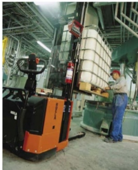
Adagolás és letöltés konténerből a targoncamérleg segítségével
