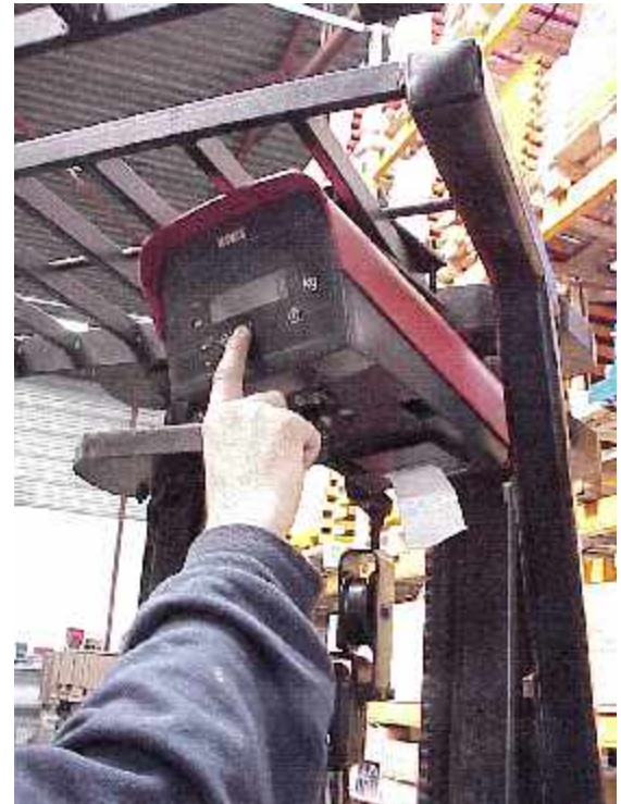
A kijelző a kezelőfülkében, kommunikáció a mérlegvillákkal rádiós adatátvitellel (RF változat)
