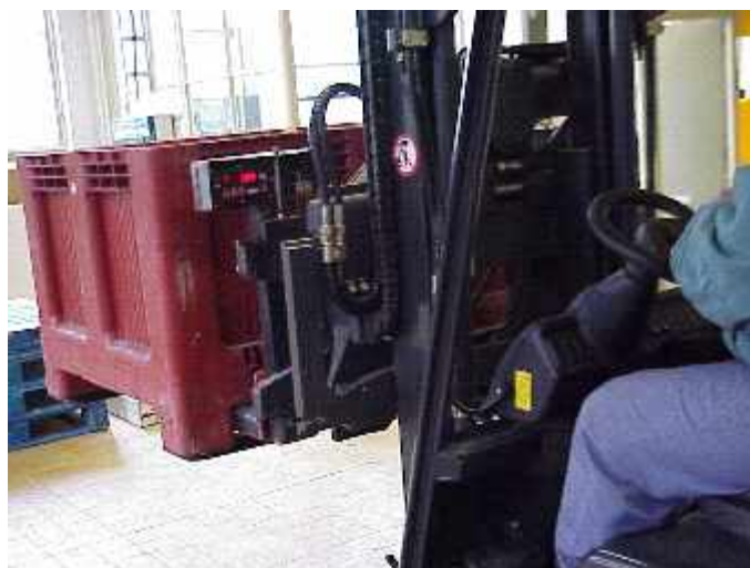
Kijelző a baloldali villára szerelve
